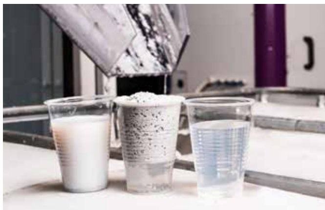
AxoPur-systemet fångar upp vattenföreningarna i en flock, som är självtorkande genom kemisk konversion, oxidering.
