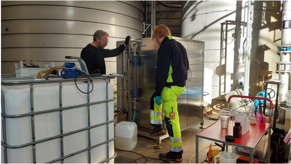
TESTING: Her testkjøres en av maskinene til Axolot i Sverige. De største rensemaskinene kan per nå rense 300 kubikk med vatn per time.
