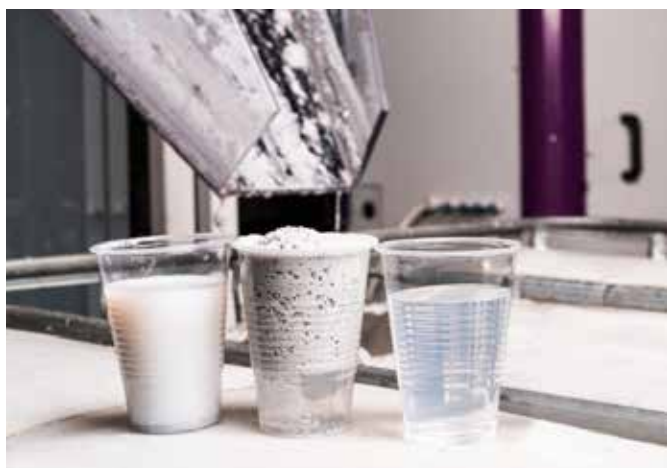
AxoPur-systemet fångar upp vattenföroreningarna i en flock, som är självtorkande genom kemisk konversion, oxidering.
