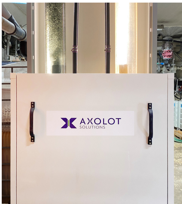
Rening av vatten från bstrykning av papper.
