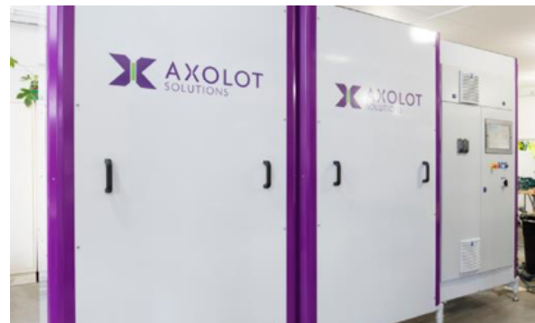
INOMHUS: Exempel på enhet med två reaktormoduler (närmast) och en kontrollmodul i bakgrunden.
